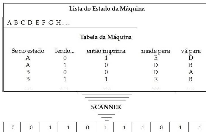
**Figura 2.2** Representação de operações na máquina de Turing.
