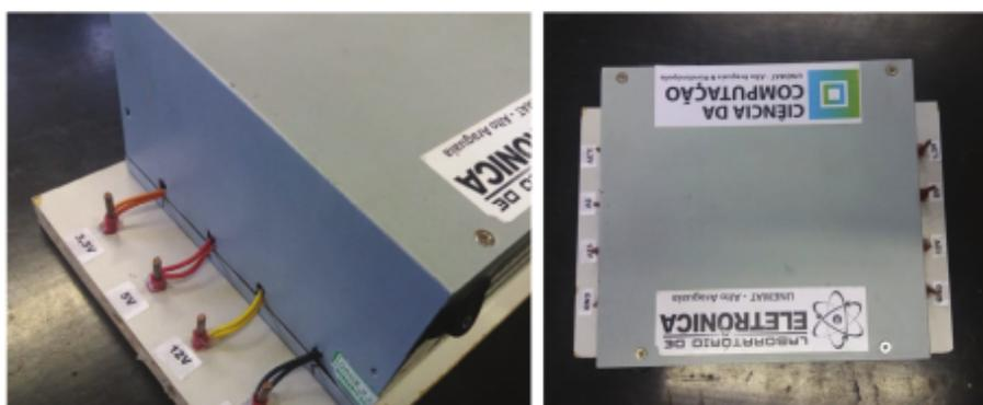
**Figura 2. Fonte de computador adaptada para funcionar como fonte de bancada.**
