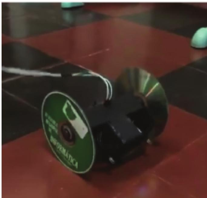
**Figura 3. Robô de controle remoto com fio e roda feitas com CD.**
