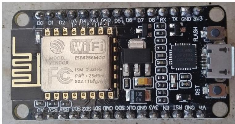
**Figura 1 – NodeMCU.**
